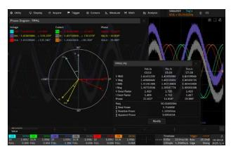
包括电力电子行业常用的交直流电源分析,能帮助用户快捷测量和分析多个项目,如电源质量、谐波、浪涌电流、开关损耗、输出纹波、瞬变响应、电源抑制比、功率效率等。搭配八通道示波器和配套的高压差分探头、电流探头,可快速搭建三相电测试环境并完成测试
