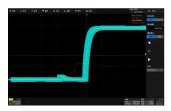
基于硬件的模板测试功能,最高每秒可执行 28000 次测试。根据用户自定义的垂直和水平容限生成模板,比较被测信号是否触碰模板,如果被测信号触碰模板则测试失败,可以预先设定测试失败时采集停止以及蜂鸣器告警,将失败帧自动截图或存入历史帧,适用于长期无人值守监测异常信号
