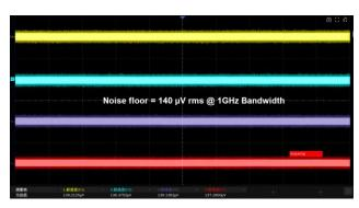
优秀的本底噪声性能,在 1 GHz 全带宽下的底噪值仅为140  $\mu$ Vrms, 让12-bit ADC 充分发挥性能
