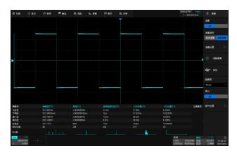
参数统计功能可显示任意参数的五种测量值: 当前值、平均值、最小值、最大值、标准差; 可同时测量统计 12 种不同的参数。直方图统计可以直观地显示参数的概率分布情况; 趋势图和轨迹图可反应参数随时间的变化规律。
