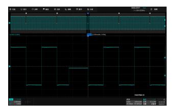
通过指定条件,对一帧波形进行自动搜索,并把符合条件的事件标识出来。结合导航功能,快速地定位到感兴趣的事件,然后借助示波器的分析功能对事件进行详细的分析,省去了手动搜索的耗时和不便。导航可以对搜索事件导航,也可以对时间和历史帧导航
