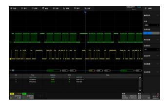
通过事件列表显示解码,能快速、直观地将总线的协议信息以表格形式显示。支持 I<sup>2</sup>C、SPI、UART、CAN、LIN、CAN FD、FlexRay、I<sup>2</sup>S、MIL-STD-1553B、SENT、Manchester 和 ARINC429 等多种协议
