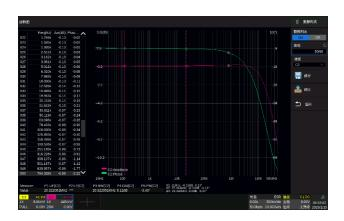
利用波特图测试系统的频率响应或环路稳定性,在一定领域取代昂贵的网络分析仪。可搭配波形发生器附件或 SDG 系列任意波形发生器
