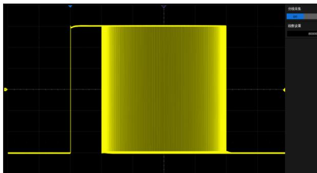
分段采集将波形储存空间分成多段，每段空间存储一个触发帧，最大可以采集 170 000 个触发事件，在 Sequence 周期内可最大限度地降低触发事件之间的间隔时间（小至 1.5 μs），提高对异常事件的捕获概率。Sequence 模式下采集的所有波形段可以一次性全部映射到屏幕上，也可以通过 History 进行单帧回放
