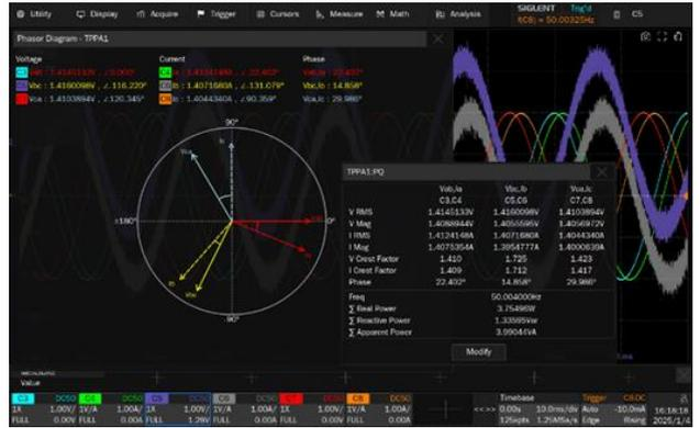
包括电力电子行业常用的交直流电源分析，能帮助用户快捷测量和分析多个项目，如电源质量、谐波、浪涌电流、开关损耗、输出纹波、瞬变响应、电源抑制比、功率效率等。搭配八通道示波器和配套的高压差分探头、电流探头，可快速搭建三相电测试环境并完成测试
