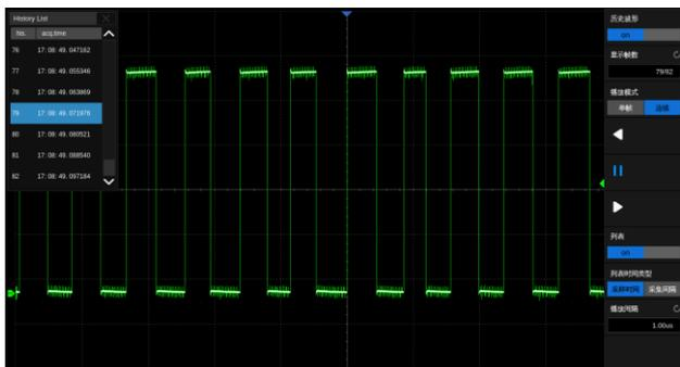
最大可记录 170 000 帧波形；自动实时录制，随时可回放历史波形观察异常事件，并通过光标或测量参数快速定位问题来源；可录制模板测试的失败帧
