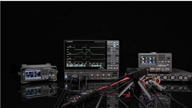
八通道示波器和光隔离探头，补全了宽禁带半导体测试的最后一块拼图。SDS5000L的上升时间达到了ps级别，可以捕捉到碳化硅 (SiC)、氮化镓 (GaN) 的快速变化的波形，分析开关过程中电压，电流的瞬态变化和开关特性。通过观察信号的形状、过冲、振铃等情况，分析信号的完整性，优化电路设计。
