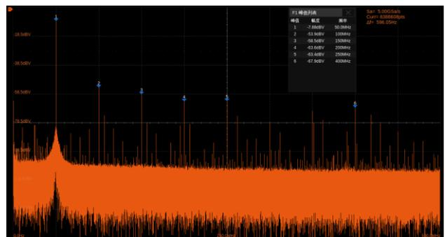
通过硬件加速的 FFT 功能，最大运算点数为 8M 点，在提供优越的频谱分辨率的同时，仍然能够保持较高的频谱刷新率。支持多种窗函数，支持普通、平均、最大值保持等模式，支持自动标记峰值点
