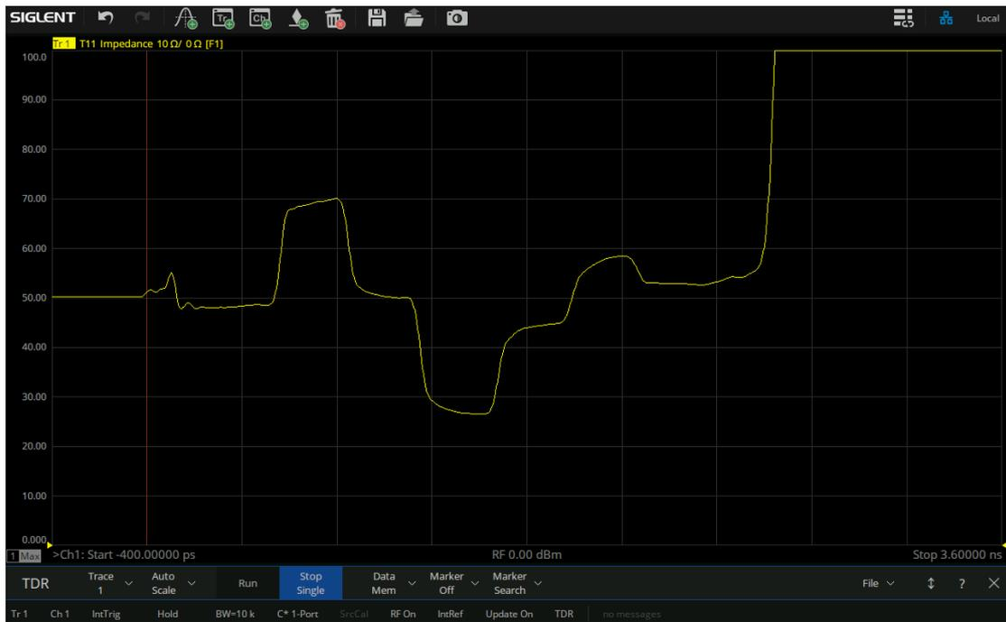
图 5 TDA 模式下的特性阻抗测试
