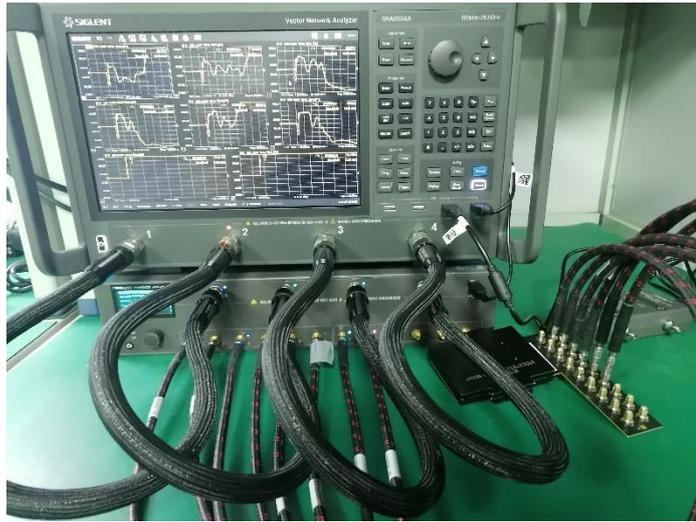
图 1 鼎阳矢量网络分析仪 SNA6000 系列配备开关矩阵 SSM5000A 开关矩阵实现 24 端口扩展
