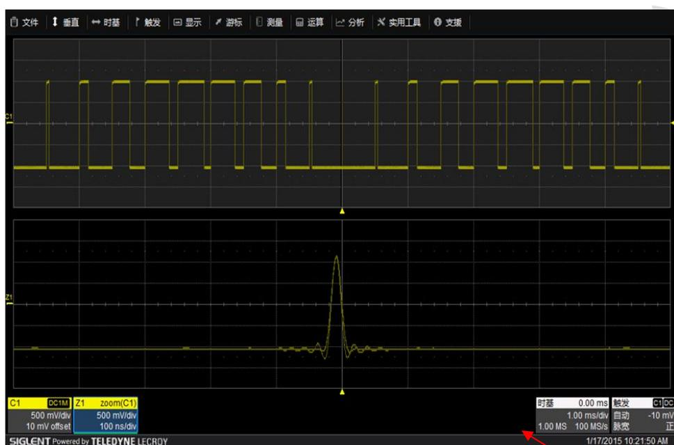
图 5 示波器实际工作中的当前采样率是受限于存储深度的
