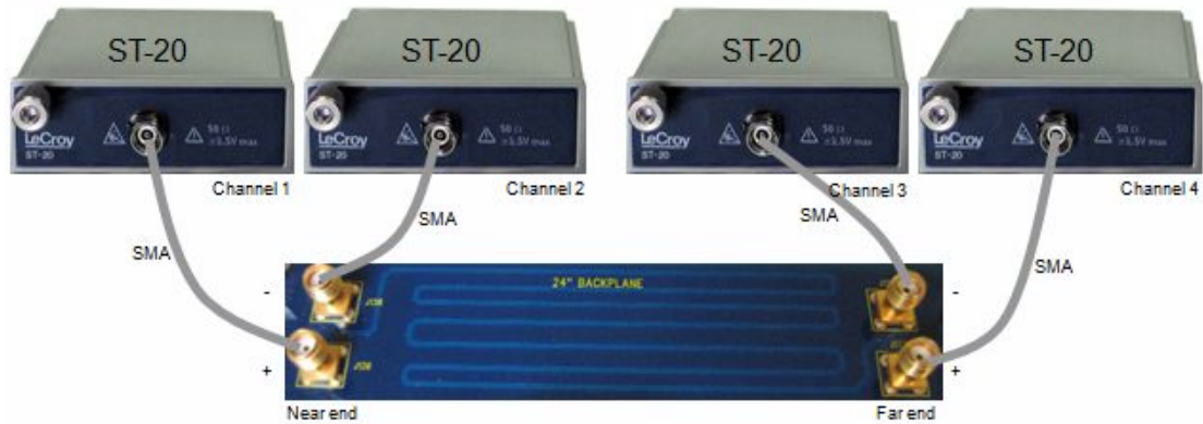
图13 基于TDR/TDT方法测量S参数
