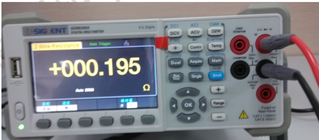
图 3 基于鼎阳科技台式万用表 SDM3055 二线制测量结果
