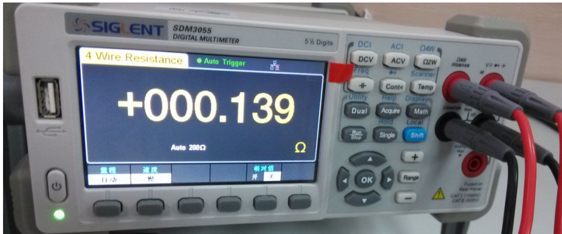
图 4 基于鼎阳科技台式万用表 SDM3055 四线制测量结果
