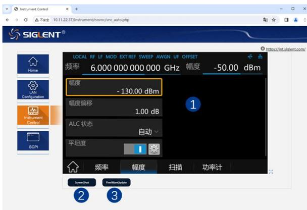
1. 仪器界面显示与控制区，该区域显示的内容为仪器显示区的拷贝。使用鼠标在该区域操作，效果等同于直接操作仪器的显示区
