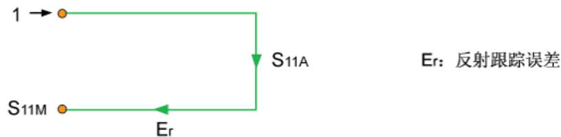
图 3-3 短路校准模型
