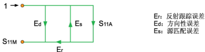
图 4-8 一端口校准模型
