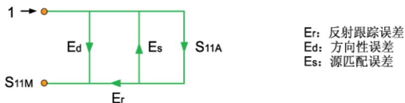
图 3-4 一端口校准模型
