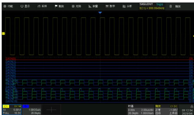
使用 16 路逻辑分析仪探头 SLA1016，可实现 16 路数字通道采集功能。数字通道与模拟通道结合，以实现混合信号采集与分析功能
