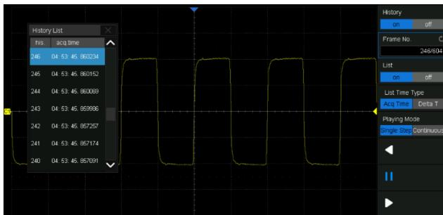
最大可记录 80000 帧波形；自动实时录制，随时可回放历史波形观察异常事件，并通过光标或测量参数快速定位问题来源
