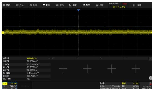
优秀的本底噪声性能，在220 MHz全带宽下的底噪值仅为70  $\mu\text{V}_{\text{rms}}$ ，让12-bit ADC充分发挥性能
