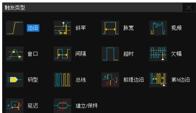
具有丰富的触发功能，包括边沿、斜率、脉宽、视频、窗口、间隔、超时、欠幅、码型、前提边沿、第N边沿、延迟、建立/保持时间和多种总线触发（串行触发）
