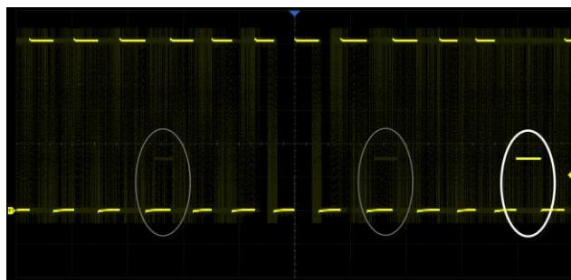
正常模式下120,000帧/秒，Sequence 模式下500,000帧/秒的波形刷新率，使示波器能轻松捕获到低概率异常事件
