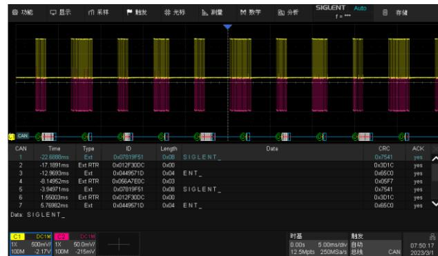
通过事件列表显示解码，能快速、直观地将总线的协议信息以表格形式显示。支持 I<sup>2</sup>C、SPI、UART、CAN、LIN、CAN FD、FlexRay多种协议。
