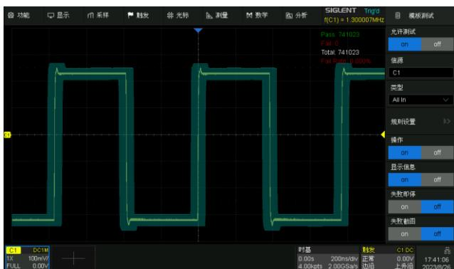
基于硬件的模板测试功能，最高每秒可执行 80000 次测试。根据用户自定义的垂直和水平容限生成模板，比较被测信号是否触碰模板，如果被测信号触碰模板则测试失败，可以预先设定测试失败时采集停止以及蜂鸣器告警，将失败帧自动截图，适用于长期无人值守监测异常信号。
