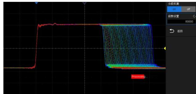
分段采集将波形储存空间分成多段，每段空间存储一个触发帧，最大可以采集 80000 个触发事件，在 Sequence 周期内可最大限度地降低触发事件之间的间隔时间（小至 $2\mu s$ ），提高对异常事件的捕获概率。Sequence 模式下采集的所有波形段可以一次性全部映射到屏幕上，也可以通过 History 进行单帧回放
