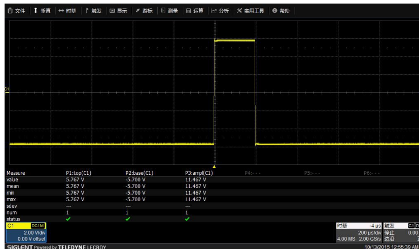
图2 鼎阳科技SDS3054测量一个脉冲方波获得高电平(top),低电平(base)和幅值(amp)
