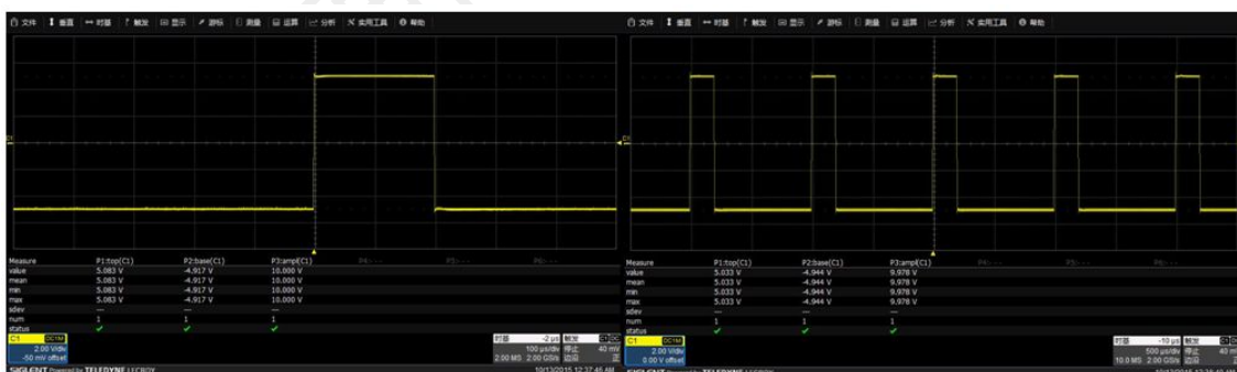
图3 鼎阳科技 SDS3054 测量 1 个脉冲方波和 5 个脉冲方波的比较
