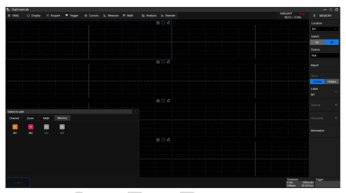
在右侧菜单栏点击源,弹框中点选 文件 标签页中的文件图标,通过文件浏览器打开电脑上存放二进制波形文件的路径。软件提供的示例文件位于安装路径目录:" C:\SigScopeLab\storage\local\"。
