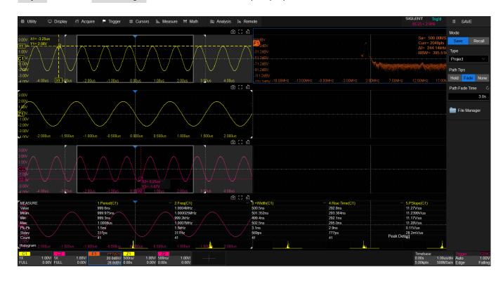
调出工程:在SigScopeLab以及本司支持工程调出的示波器设备上点击*Utility>Save/Recall...*,调出类型选择 *Project*,然后打开*File Manager*调出工程路径下的工程文件(xx.spro)。
