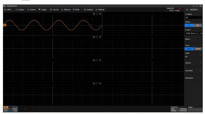
用户即可对调出的 Memory 波形进行本地离线分析。本地分析操作方法与示波器操作一致。SigScopeLab 支持 Math、测量、光标、Decode、Save/Recall 等能在离线状态下运行的功能,用户还可根据自己需求调整多窗显示效果。
