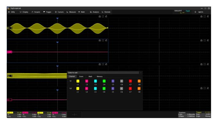
下一步:继续其他测量分析工作, 和单台设备的操作一致。需要注意的是多示波器远程采集系统下信源的格式为:示波器编号+通道号,例如 S1-1。
