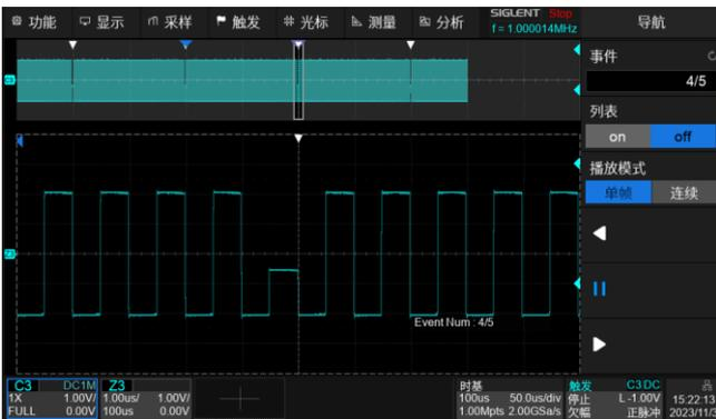
通过指定条件，对一帧波形进行自动搜索，并把符合条件的事件标识出来。结合导航功能，快速地定位到感兴趣的事件，然后借助示波器的分析功能对事件进行详细的分析，省去了手动搜索的耗时和不便。导航可以对搜索事件导航，也可以对时间和历史帧导航
