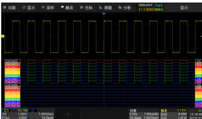
使用 16 路逻辑分析仪探头 SLA1016，可实现 16 路数字通道采集功能。数字通道与模拟通道结合，以实现混合信号采集与分析功能
