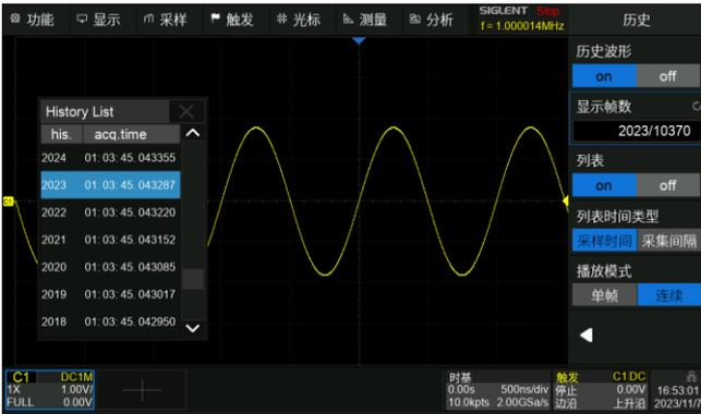
最大可记录 80000 帧波形；自动实时录制，随时可回放历史波形观察异常事件，并通过光标或测量参数快速定位问题来源
