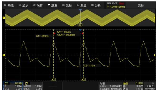
最大100 Mpts/通道的深存储，使用户能够使用更高的采样率捕获更长时间的信号，结合水平和垂直方向上的缩放功能，做到整体与细节的兼顾
