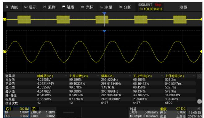
参数统计功能可显示任意参数的五种测量值：当前值、平均值、最小值、最大值、标准差。直方图统计可以直观地显示参数的概率分布情况；趋势图和轨迹图可反应参数随时间的变化规律。
