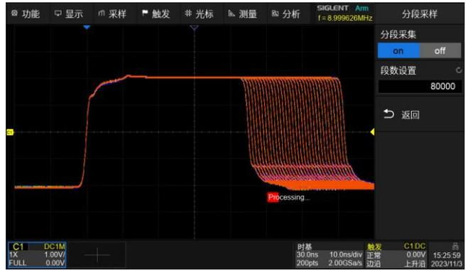
分段采集将波形储存空间分成多段，每段空间存储一个触发帧，最大可以采集 80000 个触发事件，在 Sequence 周期内可最大限度地降低触发事件之间的间隔时间（小至2 μs），提高对异常事件的捕获概率。Sequence 模式下采集的所有波形段可以一次性全部映射到屏幕上，也可以通过 History 进行单帧回放
