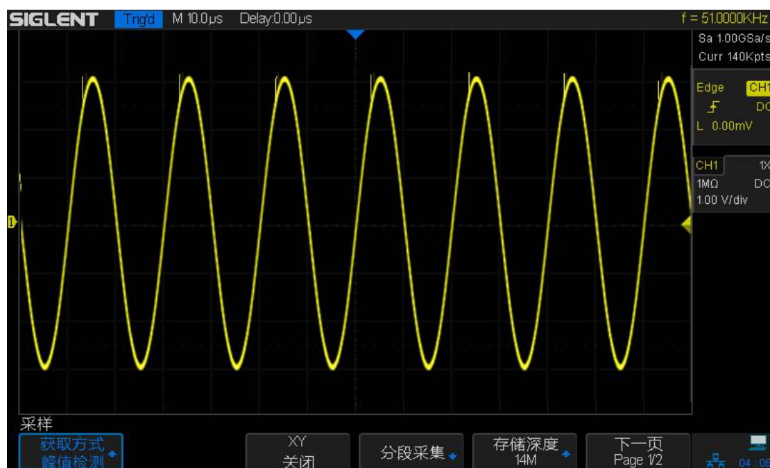
图 27 带毛刺的正弦波（峰值检测模式）
