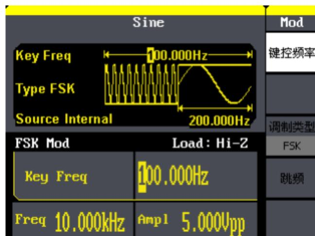
图 3-13 输出 FSK 调制波形
