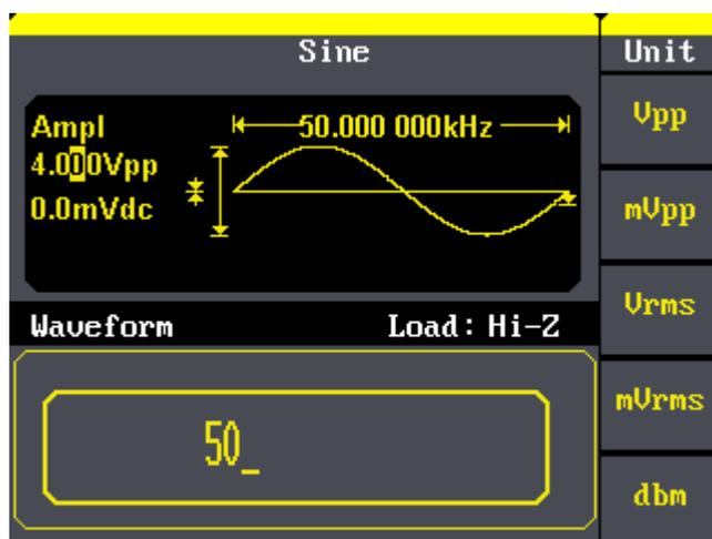
图 2-3 正弦波幅值设置界面
