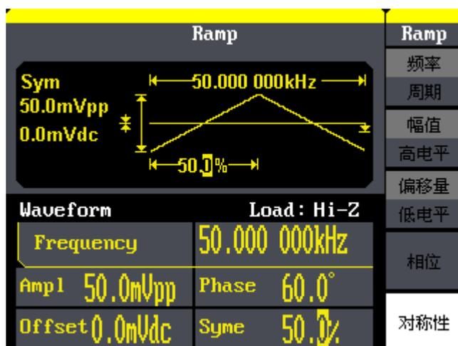
图 2-8 锯齿波/三角波参数显示界面
