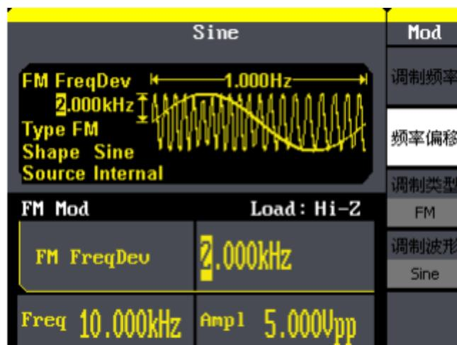
图 3-11 输出 FM 调制波形
