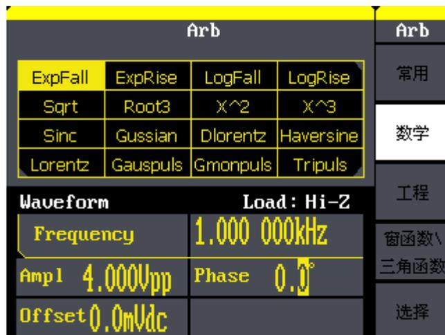
图 2-17 数学函数内建波形显示界面
