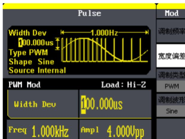
图 3-15 输出 PWM 调制波形
