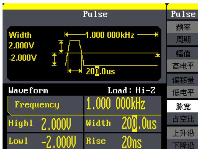
图 2-10 脉冲波参数显示界面
