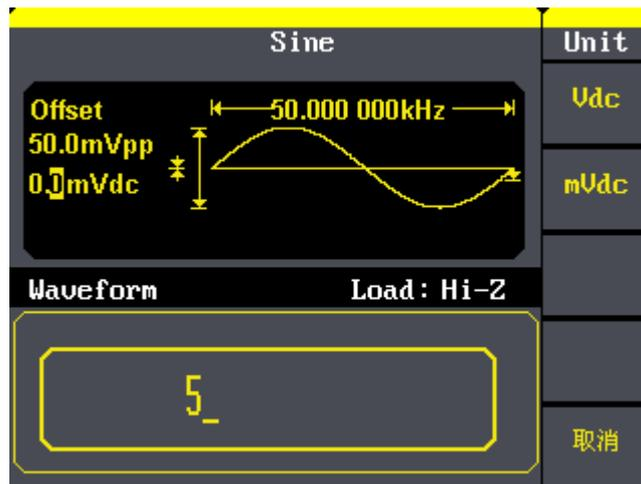
图 2-4 正弦波偏移量设置界面
