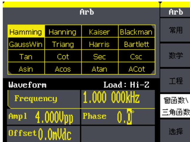
图 2-19 窗函数\三角函数内建波形显示界面
