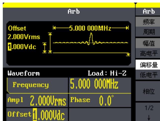
图 3-6 输出存储的任意波形
