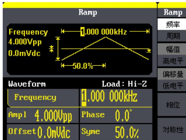
图 1-8 锯齿波/三角波参数设置界面
