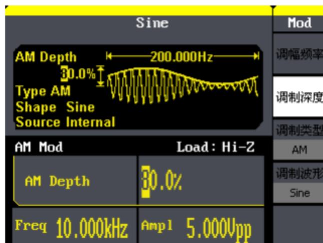
图 3-9 输出 AM 调制波形
