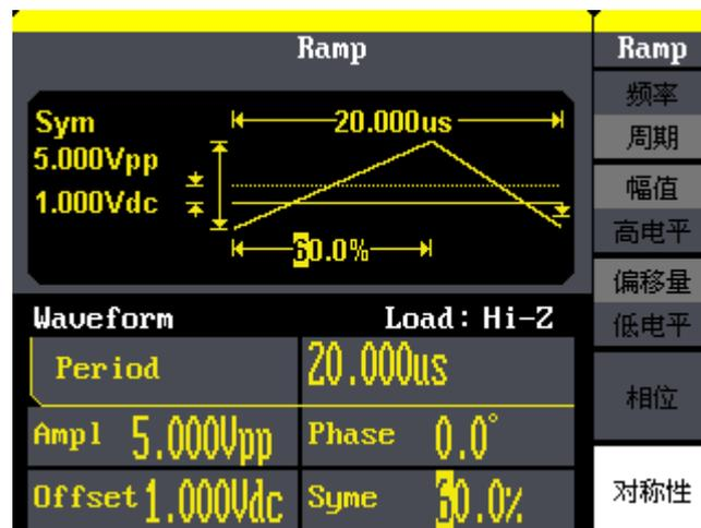
图 3-3 输出三角波/锯齿波形
