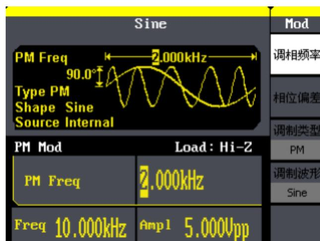
图 3-12 输出 PM 调制波形
