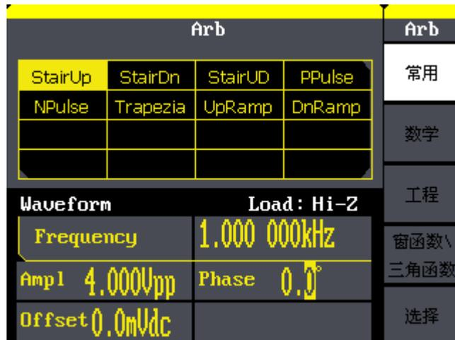
图 2-16 常用函数内建波形显示界面
