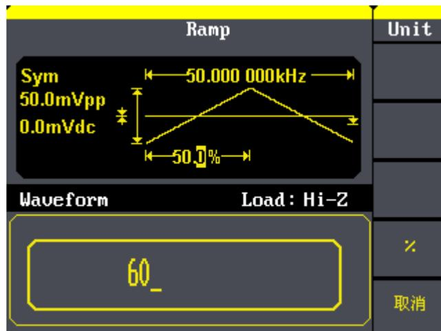
图 2-9 锯齿波/三角波对称性设置界面
