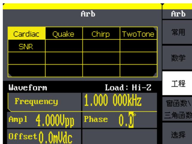
图 2-18 工程函数内建波形显示界面
