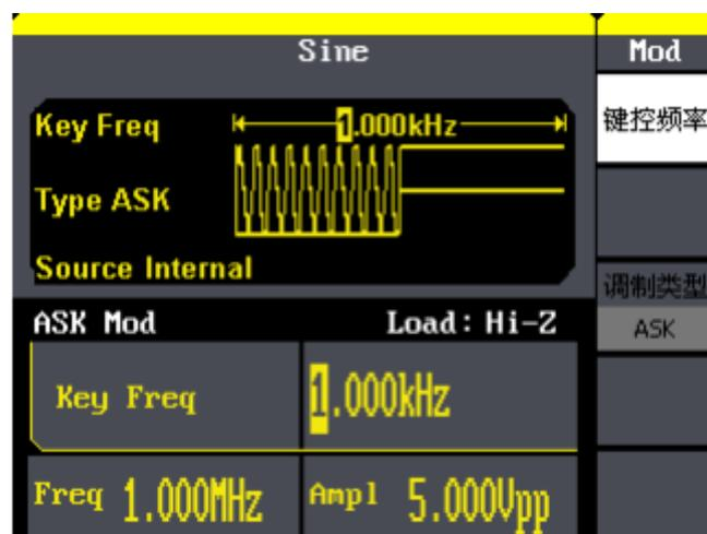
图 3-14 输出 ASK 调制波形
